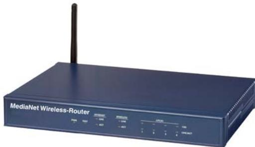
Mit der Basis-Station WebControl-Modul wireless-Router können drahtlose BuildNet Systemkomponenten an das MediaNet Ethernet-Netzwerk angeschlossen werden.. Die Verwendung des IEEE-Standards 802.11 für lokale Funk-Netzwerke (Wireless LANs) garantiert eine ausgereifte Technologie und die Kompatibilität zu Geräten anderer Hersteller. Die Bandbreite im Funknetz beträgt 11 Mbit/s. Die Konfiguration erfolgt über einen Standard-WEB-Browser.
