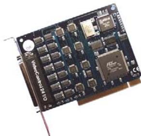
Erweiterungsboard mit 24 potentialfreien Alarmeingängen für den Buildnet VideoControlserver. Zum Anschluss von zusätzlichen Alarmmeldern oder Alarmgeber. Die Kanäle sind beliebig als Ein- oder Ausgänge konfigurierbar.
