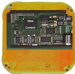
Es können bis zu 2 Räume mit diesem WebControl-Modul gesteuert werden. Mit jeweils 2 Beleuchtungsstromkreise, 1 Temperaturfühler, 2 Vorhänge(Sonnenschutz), 3 Sensoren (z.B. Alarmmelder, Rauchmelder etc.) und 1 Transponder-Sensor für die Zutrittskontrolle. Die Bedienung vor Ort kann über Taster, Doppeltaster, Drehregler aus einem Standard Schalterprogramm erfolgen oder über einen PC, PDA, Telefon, LCD Wandeinbautableau etc. erfolgen.
