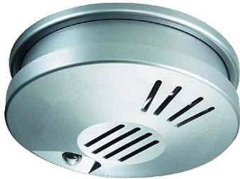
Streulicht-Rauchmelder für das WebControl-Modul office. Mit integriertem Warnton (85 dB/3m), dezentraler Meldung und batteriebetriebener Notstromfunktion. VdS Zulassung 12239.
