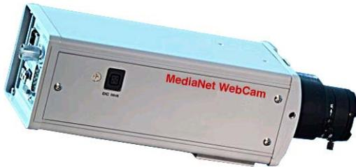
Die hochwertige Netzwerkkamera mit "Wide Dynamic Range" Funktion ermöglicht die Live-Videoübertragung in bester Bildqualität über das BuildNet Ethernet-Netzwerk. Die BuildNet WebCam verwendet neben dem Standard H.323 für Videokonferenzsysteme auch M-JPEG für die Videoübertragung. Integrierter Webserver über TCP/IP und Webbrowser steuerbar und konfigurierbar.
