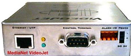
Das WebControl-Modul VideoJet ermöglicht die Übertragung von Live-Videobildern und Audio über das BuildNet Ethernet-Netzwerk. Durch die effiziente Komprimierung gemäß dem ITU-T Standard H.261 kann eine Verbindung über beliebige TCP/IP-Verbindungen sowohl im lokalen Netzwerk als auch im Internet (Wide Area Network) erfolgen. Integrierter Webserver über TCP/IP und Webbrowser steuerbar und konfigurierbar.
